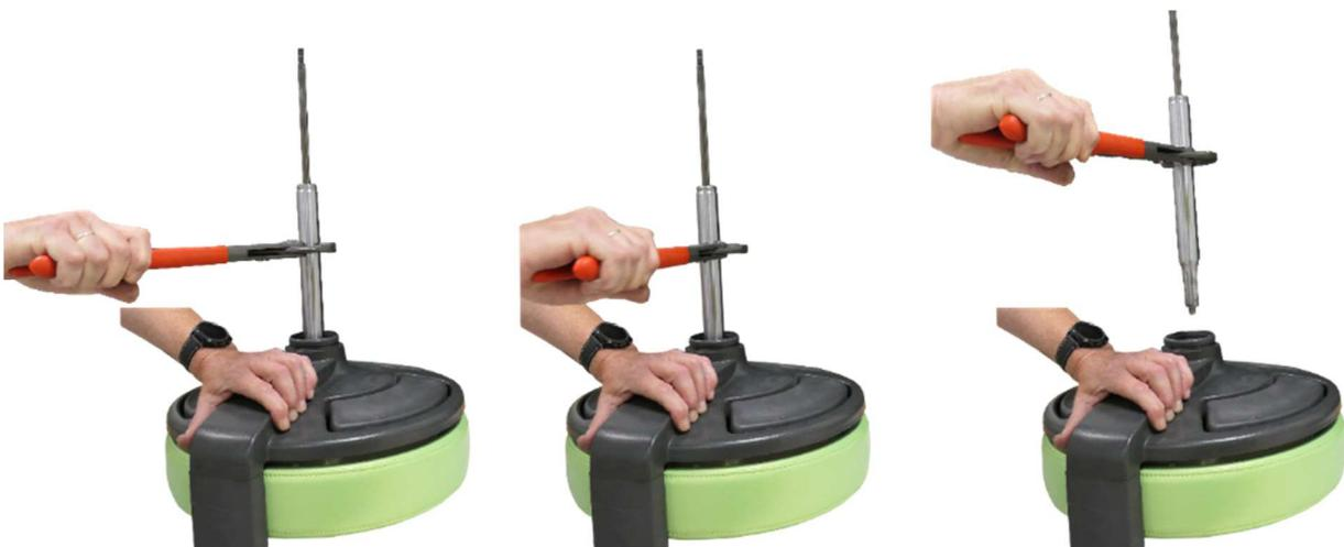
Retirer la rondelle interne (peut être jetée) à l'aide d'un outil magnétique. Si la rondelle s'est déplacée et ne peut pas être retrouvée, la laisser en place et passer à l'étape suivante. Ensuite, essuyer l'excès d'huile en spray dans l'ouverture de serrage avec un chiffon.
