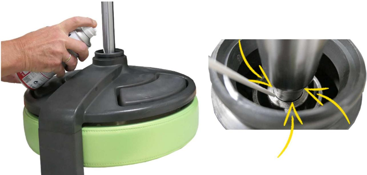
À l'aide d'une clé à tube et, si nécessaire, avec l'aide d'une seconde personne qui maintient le cadre, essayer de desserrer le vérin à gaz de son enclavement. Cette étape est laborieuse et peut ne pas réussir du premier coup.
