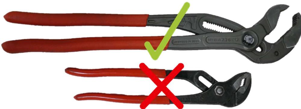
Saisir le manchon de fixation avec la clé à tube et essayer de le desserrer en le bougeant d'avant en arrière. Ensuite, essuyer l'excès d'huile dans l'ouverture de serrage avec un chiffon.
