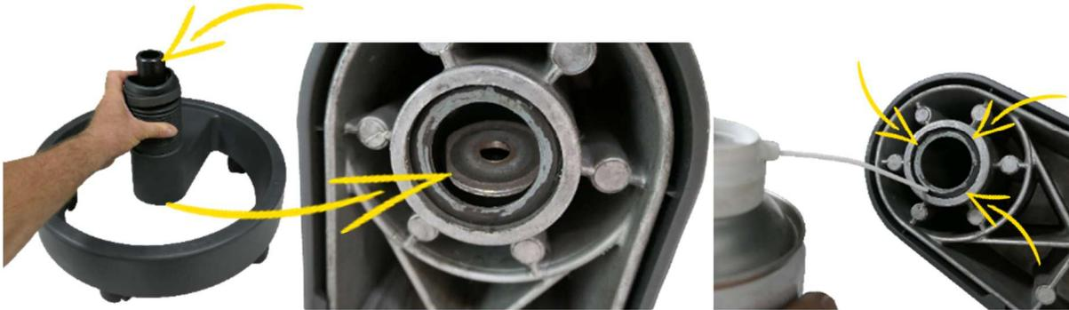
L'utilisation d'une clé à tube standard d'un atelier de loisirs ne suffira généralement pas à retirer le manchon de fixation. Il est recommandé d'utiliser une clé à tube professionnelle. Plus le manche est long, plus la transmission de force est élevée. Longueur de manche recommandée : au moins 350 mm (14 pouces).
